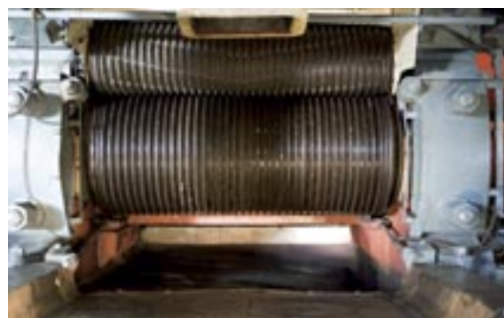
Cylindres de concassage de cannes à sucre
