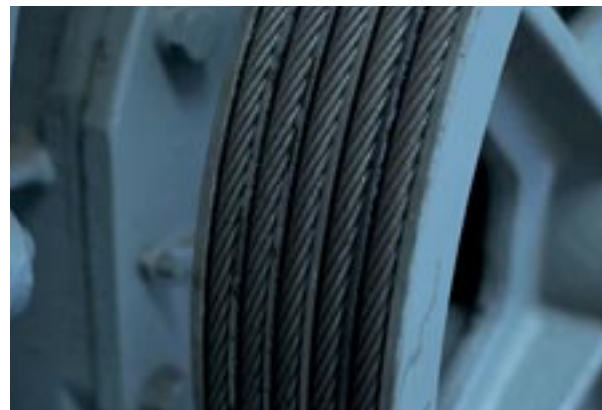
Câbles de traction, ascenseurs, monte-charge, sas, écluses
